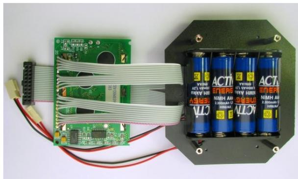
Bei Bedarf können die unteren Batterien mittels der beiliegenden Kabelbinder fixiert werden. Dazu werden die Kabelbinder durch die verbleibenden vier Löcher über beide Batteriehalter gespannt.
