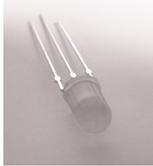
Die mehrfarbigen LEDs **LED0** und **LED1** haben drei Beinchen, ein kurzes (grüne Anode), ein langes (gemeinsame Kathode) und ein mittleres (rote Anode). Das Beinchen mit der **mittleren** Länge muss in das **rechteckige** Lötpad.
