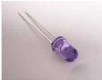
Die IR-LEDs **PE1-PE5** dienen zur Aussendung der IR-Strahlung, sie werden auf der **Oberseite** der Platine eingelötet.
