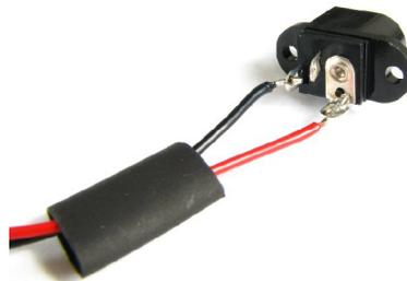
Nach dem Lötten werden die Anschlüsse mit dem Schrumpfschlauch isoliert:
