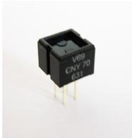
Die vier IR-Reflexlichtschranken **U1-U4** vom Typ CNY70 werden von der **Unterseite** der Platine bestückt (zwei innen und zwei am äußeren Rand der Platine). Die Lichtschranken bestehen aus einer IR-LED (blaues Fenster) und einem IR-Phototransistor (dunkles Fenster in Richtung des Aufdrucks).
