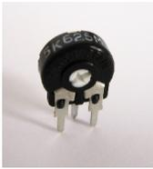
Beim Einbau des Potentiometers **R15** muss auf die richtige **Orientierung** geachtet werden. Der Einbau ist nur in einer Richtung möglich. Das Potentiometer dient zum Einstellen des Displaykontrastes.
