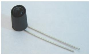
Außerdem werden die Phototransistoren durch 8 mm lange Schrumpfschlauch-Stücke abgeschirmt. Dafür müssen die Schrumpfschlauch-Stücke ca. 1 mm nach unten über den Boden der Phototransistoren hinausragen und mit Hitze (am besten mit Heißluft, notfalls mit dem LötKolben, dabei aber mindestens 2 mm Abstand halten!) zum Schrumpfen gebracht werden.
