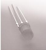
Die mehrfarbigen LEDs **LED0** und **LED1** haben drei Beinchen, ein kurzes (grüne Anode), ein langes (gemeinsame Kathode) und ein mittleres (rote Anode). Das Beinchen mit der **mittleren** Länge muss in das **rechteckige** Lötpad.
