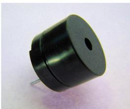
Bei dem Miniatur-Lautsprecher **SP1** muss die Polarität beachtet werden: Der **Pluspol** ist sowohl am Lautsprecher als auch auf der Platine gekennzeichnet.
