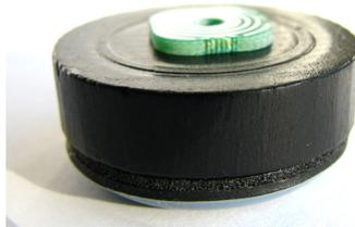
Dann wird die Scheibe mit der Holzschraube mittig auf der Unterseite der Platine befestigt:
