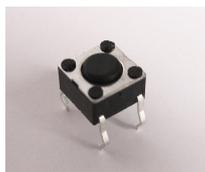
Der Einbau der Taster **S2** (Resettaster) und **S3** (Funktionstaster) ist verpolungssicher. Er muss mit leichtem Druck bis zum Einrasten bestückt werden. Da das Pinout **nicht** quadratisch ist, sind nur **zwei** der vier Orientierungen möglich.
