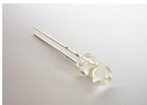
Die beiden weißen LEDs **LED8** und **LED9** werden direkt am Boden der LED abgewinkelt. Dabei muss die **Polarität** beachtet werden: Das **kurze** Beinchen muss jeweils in das **rechteckige** Löt看垫.
