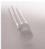
Die mehrfarbigen LEDs **LED2-LED7** haben drei Beinchen, ein kurzes (grüne Anode), ein langes (gemeinsame Kathode) und ein mittleres (rote Anode). Das Beinchen mit der **mittleren** Länge muss in das **rechteckige**
