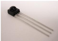
Beim Einbau des Infrarot Empfangs-ICs **U5** muss die korrekte **Orientierung** beachtet werden: die Ausrichtung der Halbkugel ist auf dem Bestückungsdruck erkennbar!
