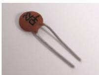
Die beiden Scheibenkondensatoren C1 und C2 haben eine Kapazität von 22 pF (Aufdruck: 22), auf eine Polarität muss nicht geachtet werden.
