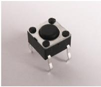
Der Einbau des Reset-Tasters S2 ist verpolungssicher. Er kann in zwei Orientierungen eingesetzt werden.
