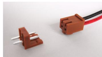
eingelötet werden. Die Nase der Stecker ist auf dem Bestückungsaufdruck erkennbar. Bei dem weißen Stromversorgungsstecker zeigt die Nase in Richtung Platinenmitte, bei den beiden braunen Motorsteckern zeigt die Nase zur Platinenmitte. Die Kabel werden erst später an die Motoren und den Batteriehalter angelötet.
