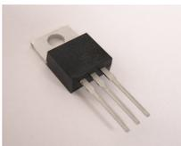
Da der Spannungsregler IC4 mechanisch an der Antriebssektion befestigt wird, wird er jetzt **noch nicht eingelötet**, sondern nur die Beinchen zurecht gebogen: Sie müssen so gebogen werden, dass die Bohrung des Bauteils genau mit der Bohrung der Platine zusammenfällt. Das Bauteil wird später, nach dem mechanischen Zusammenbau eingelötet.
