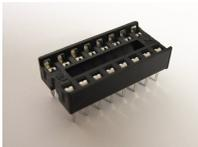
Für den Motortreiber-IC L293D (IC2) wird ein Sockel auf der Platine eingelötet. Die **Einkerbung** im Sockel muss in die selbe Richtung zeigen, wie die Markierung auf der Platine. Der IC wird noch nicht bestückt!
