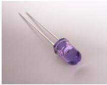
Die IR-LEDs PE1-PE5 dienen zur Aussendung der IR-Strahlung, sie werden auf der Oberseite der Platine eingelötet. Die Beinchen werden ca. 3 mm vom Boden des Phototransistors abgewinkelt, am besten legt man dazu ein 3mm dickes Material (Schraubenzieher o.Ä.) dazwischen.
