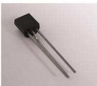
Die beiden N-MOSFET-Transistoren (T5 und T6) sind vom Typ BS170. Bei der Bestückung ist darauf zu achten, dass die abgeflachte Seite der Transistoren in die gleiche **Orientierung** zeigt, wie auf der Platine angegeben ist.
