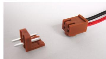
eingelötet werden. Die Nase der Stecker ist auf dem Bestückungsaufdruck erkennbar. Bei dem weißen Stromversorgungsstecker zeigt die Nase in Richtung Platinenmitte, bei den beiden braunen Motorsteckern zeigt die Nase zum Platinenrand. Die Kabel werden erst später an die Motoren und den Batteriehalter angelötet.
