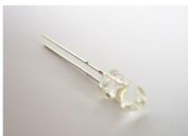
Die beiden weißen LEDs D1 und D2 werden genauso wie die IR-LEDs abgewinkelt (3mm). Dabei muss die **Polarität** beachtet werden: Das **kurze** Beinchen muss jeweils in das rechteckige Lötpad.
