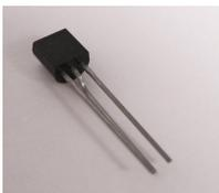
Die vier NPN-Bipolar-Transistoren (T1, T2, T3 und T4) sind vom Typ BC368. Bei der Bestückung ist darauf zu achten, dass die abgeflachte Seite der Transistoren in die gleiche **Orientierung** zeigt, wie auf der Platine angegeben ist.
