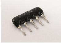
Bei jedem Widerstandsnetzwerk ist der Pin 1 durch einen **Punkt** markiert. Auf der Platine ist der Pin 1 durch ein rechteckiges Löt-Pad markiert. Folgende Widerstandsnetzwerke werden bestückt:
