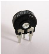
Beim Einbau des Potentiometers R15 muss auf die richtige **Orientierung** geachtet werden. Der Einbau ist nur in einer Richtung möglich.
