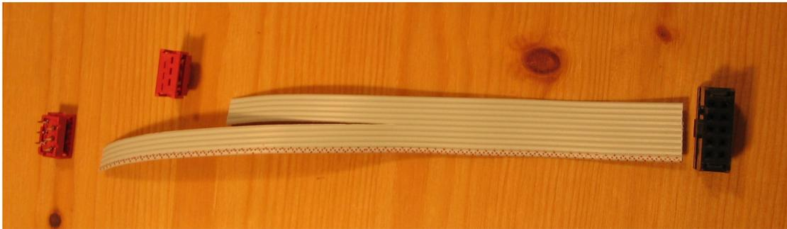
Das Flachbandkabel muss zunächst auf 14 cm gekürzt werden. Dann wird das Kabel von einer Seite auf einer Länge von 7 cm in zwei 5-polige Stränge aufgeteilt. Der Strang mit der **ersten (rot markierten)** Ader behält die Länge von **14 cm**, der andere wird auf 10,5 cm gekürzt.
