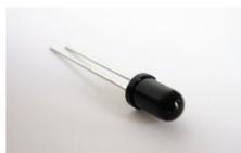
Die Phototransistoren PT1-PT5 dienen zur Messung der reflektierten IR-Strahlung. Um sie möglichst unempfindlich gegenüber störenden Einflüssen zu machen, werden sie auf der Unterseite der Platine eingelötet. Die Beinchen werden ca. 1 mm vom Boden des Phototransistors abgewinkelt, am besten legt man dazu ein 1mm dickes Material (Messer o.Ä.) dazwischen. Dabei muss die **Polarität** beachtet werden: Das **kurze** Beinchen muss jeweils in das rechteckige Lötpad.
