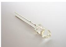
Die beiden weißen LEDs D1 und D2 werden genauso wie die IR-LEDs abgewinkelt (3mm). Dabei muss die **Polarität** beachtet werden: Das **kurze** Beinchen muss jeweils in das rechteckige Lötpad.
