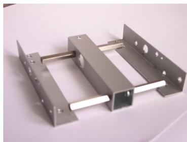
Legen Sie die Motoren so zwischen L-Profil und Vierkantprofil, dass die Kondensatoren zur Oberseite zeigen. Schrauben Sie nun die L-Profile mit den 12 mm Bolzen fest.
