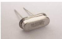
Der Quarz Q1 hat einen Frequenz von 16,000MHz. Das Gehäuse sollte nach dem Einbau keinen Kontakt zur Platine haben (optimal: 1mm Abstand zur Platine). Eine Polarität muss beim Einbau nicht beachtet werden.
