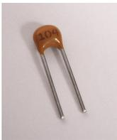
Die Platine wird mit insgesamt zehn Keramik-Vielschicht-Kondensatoren bestückt. Dabei haben die Kondensatoren C7 und C10 einen Wert von 220 nF (Aufdruck: 224), die Übrigen Kondensatoren (C3, C4, C8, C11, C12, C13, C14 und C15) haben einen Wert von 100 nF (Aufdruck: 104). Es muss beim Einbau keine Polarität beachtet werden.
