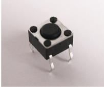
Der Einbau des Reset-Tasters S2 ist verpolungssicher. Er muss mit leichtem Druck bis zum Einrasten bestückt werden. Da das Pinout nicht quadratisch ist, sind nur zwei der vier Orientierungen möglich.
