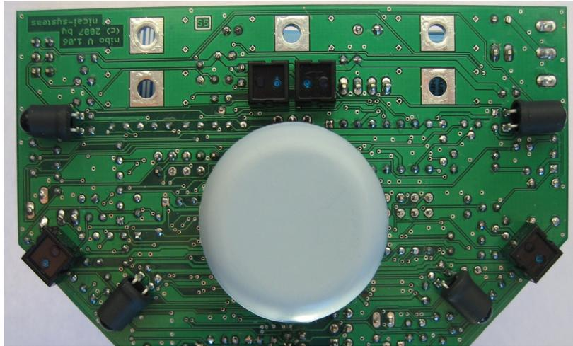
Die Pins der Reflexlichtschranken dürfen nach dem Einlöten und anschließendem Kürzen **höchstens** noch 0,7 mm lang sein, da sie sonst den Boden des Spannungsreglers berühren werden!
