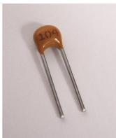
Die Platine wird mit insgesamt zehn Keramik-Vielschicht-Kondensatoren bestückt. Dabei haben die Kondensatoren C7 und C10 einen Wert von 220 nF (Aufdruck: 224), die Übrigen Kondensatoren (C3, C4, C8, C11, C12, C13, C14 und C15) haben einen Wert von 100 nF (Aufdruck: 104). Es muss beim Einbau keine Polarität beachtet werden.
