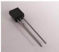
Die vier NPN-Bipolar-Transistoren (T1, T2, T3 und T4) sind vom Typ BC368. Bei der Bestückung ist darauf zu achten, dass die abgeflachte Seite der Transistoren in die gleiche **Orientierung** zeigt, wie auf der Platine angegeben ist.
