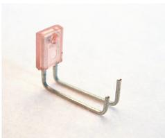
Nun müssen die beiden IR-LEDs (IRL80A) mit einer Zange so umgebogen werden, dass die Linse in Richtung der abgewinkelten Beinchen zeigt. Das Stück vom Plastikkörper bis zur ersten Biegung muss 2 mm lang sein und das mittlere Stück muss 10mm lang sein. Die beiden LEDs können jetzt von hinten an die Odometriesensorplatinen gelötet werden.
