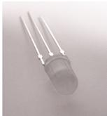
Die mehrfarbigen LEDs LED2-LED7 haben drei Beinchen, ein kurzes (grüne Anode), ein langes (gemeinsame Kathode) und ein mittleres (rote Anode). Das Beinchen mit der **mittleren** Länge muss in das rechteckige Lötpad. Als weiteres Merkmal ist das Gehäuse in Richtung des mittellangen Beinchens abgeflacht, dies ist auch auf der Platine gekennzeichnet.
