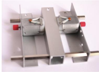
Anschließend werden die Odometriesensorplatten mit den 5 mm langen M2 Senkkopfschrauben (es gibt auch 6 mm lange Schrauben!) und Muttern befestigt.
