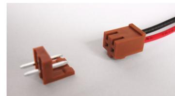
eingelötet werden. Die Nase der Stecker ist auf dem Bestückungsaufdruck erkennbar. Bei dem weißen Stromversorgungsstecker zeigt die Nase in Richtung Platinenmitte, bei den beiden braunen Motorsteckern zeigt die Nase zum Platinenrand. Die zugehörigen Kabel werden erst später an die Motoren und den Batteriehaltern angelötet.
