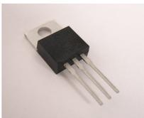
Da der Spannungsregler IC4 mechanisch an der Antriebssektion befestigt wird, wird er jetzt **noch nicht eingelötet**, sondern nur die Beinchen zurecht gebogen: Sie müssen so gebogen werden, dass die Bohrung des Bauteils genau mit der Bohrung der Platine zusammenfällt. Das Bauteil wird später, während des mechanischen Zusammenbaus eingelötet.
