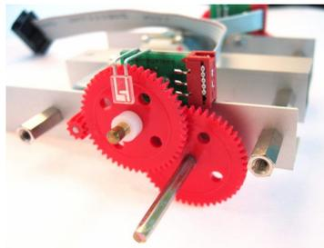
Abschließend wird das Getriebe mit einer Aluminiumabdeckplatte und zwei Innensechskantschrauben fixiert. Analog verfährt man auf der anderen Seite.
