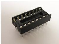
Für den Motortreiber-IC L293D (IC2) wird ein Sockel auf der Platine eingelötet. Die **Einkerbung** im Sockel muss in die selbe Richtung zeigen, wie die Markierung auf der Platine. Der IC wird erst später in den Sockel gesteckt.
