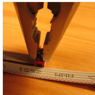
Jetzt wird noch der zweite 6-polige Krimpkontakt am kürzeren Strang aufgekrimpt. Dazu muss das Kabel zunächst umgedreht werden. An den Pin
