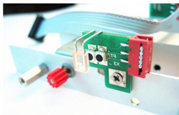
Nun müssen auf beiden Seiten die Getriebe montiert werden. Dazu wird eine sechseckige Antriebsachse (inkl. Doppelzahnrad) so in die hintere Bohrung gesteckt, dass das kleine Zahnrad nach innen zeigt. Danach wird die runde Messingachse (inkl. Doppelzahnrad) so in die andere Bohrung gesteckt, dass das kleine Zahnrad nach innen zeigt. Dafür muss die IR-LED leicht nach oben gebogen werden. Auf die runde Messingachse wird nun noch ein Kunststoffdistanzring aufgesteckt.
