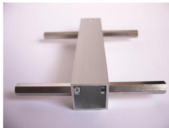
Im nächsten Schritt wird an jeder Seite ein L-Profil befestigt. Dazu legen Sie das Vierkantprofil und die beiden L-Profile so vor sich hin, wie auf der Abbildung gezeigt. Die Oberseite des Vierkantprofils erkennt man daran, dass sich dort die große Bohrung für die Motoren näher am Rand befindet.
