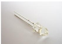
Die beiden weißen LEDs LED1 und LED8 werden genauso wie die IR-LEDs abgewinkelt (3mm). Dabei muss die **Polarität** beachtet werden: Das **kurze** Beinchen muss jeweils in das rechteckige Lötpad.
