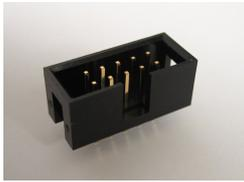
Die vier Wannenstecker (X6, X7, X8 und X9) müssen in der richtigen **Orientierung** auf die Platine gelötet werden. Die Aussparungen an den Wannen sind auf dem Bestückungsdruck sichtbar. Die 6-polige Wanne X8 dient zur Programmierung des Roboters. Eine 10-polige Wanne X7 dient zum Anschluss der Odometrieplatten. Die zweite 10-polige Wanne X6 stellt den Erweiterungsport zur Verfügung. An der 20-poligen Wanne X9 lässt sich ein LC-Display anschließen.
