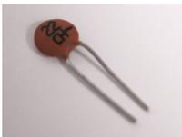
Die beiden Scheibenkondensatoren C1 und C2 haben eine Kapazität von 15 pF (Aufdruck: 15), auf eine Polarität muss nicht geachtet werden.
