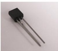
Der N-MOSFET-Transistor (T1) ist vom Typ BS170. Bei der Bestückung ist darauf zu achten, dass die abgeflachte Seite des Transistors in die gleiche **Orientierung** zeigt, wie auf der Platine angegeben ist.
