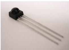
Beim Einbau des Infrarot Empfangs-ICs U1 muss die korrekte Orientierung beachtet werden, die Halbkugel muss nach außen (zum Platinenrand hin) zeigen!
