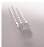
Die mehrfarbigen LED (D2) hat drei Beinchen, ein kurzes (grüne Anode), ein langes (gemeinsame Kathode) und ein mittleres (rote Anode). Das Beinchen mit der **mittleren** Länge muss in das rechteckige Lötpad. Als weiteres Merkmal ist das Gehäuse in Richtung des mittellangen Beinchens abgeflacht, dies ist auch auf der Platine gekennzeichnet.
