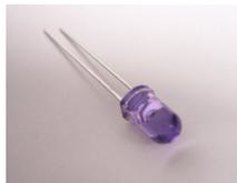
Die beiden IR-LEDs (PE1, PE2) dienen zur Aussendung der IR-Strahlung, sie werden auf der Oberseite der Platine eingelötet. Die Beinchen werden ca. 3 mm vom Boden des Phototransistors abgewinkelt, am besten legt man dazu ein 3mm dickes Material (Schraubenzieher o.Ä.) dazwischen.
