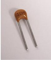
Die beiden Keramik-Vielschicht-Kondensatoren C5 und C6 haben einen Wert von 100 nF (Aufdruck: 104). Beim Einbau muss keine Polarität beachtet werden.
