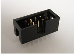
Der 6-polige Wannenstecker (X2) muss in der richtigen **Orientierung** auf die Platine gelötet werden. Die Aussparung an den Wanne ist auf dem Bestückungsdruck sichtbar.
