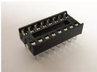
Es werden zwei **14-polige** IC-Sockel so nebeneinander eingelötet, dass man einen 28-poligen Sockel für den ATmega8 erhält. Die **Einkerbung beider** Sockel muss in die selbe Richtung zeigen, wie die Markierung auf der Platine. **Der IC wird erst später in die Sockel gesteckt!**
