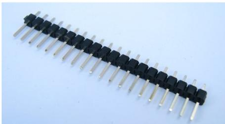
Die 20-polige Stiftleiste wird auf der BGX1-Platine direkt unterhalb der Taster und der LEDs eingelötet (siehe Foto).
