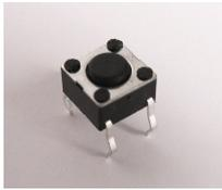
Der Einbau der Taster **S1 - S4** ist verpolungssicher. Sie müssen mit leichtem Druck bis zum Einrasten bestückt werden. Da das Pinout **nicht** quadratisch ist, sind nur **zwei** der vier Orientierungen möglich.
