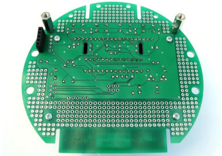
Nun wird das BGX1-Modul auf die NIBObee-Platine gesteckt. Dabei ist zu beachten, dass die 5-polige Buchsenleiste **korrekt** mit der 4-poligen Steckerleiste kontaktiert wird. Beide Leisten müssen nach **vorne** (in Fahrtrichtung) **bündig** abschließen:
