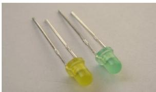
Die LEDs **LED1 - LED4** haben zwei Beinchen, ein kurzes (Kathode) und ein langes (Anode). Beim Einlöten muss die **Polarität** beachtet werden: Das **kurze** Beinchen muss jeweils in das **rechteckige** Lötpad.
