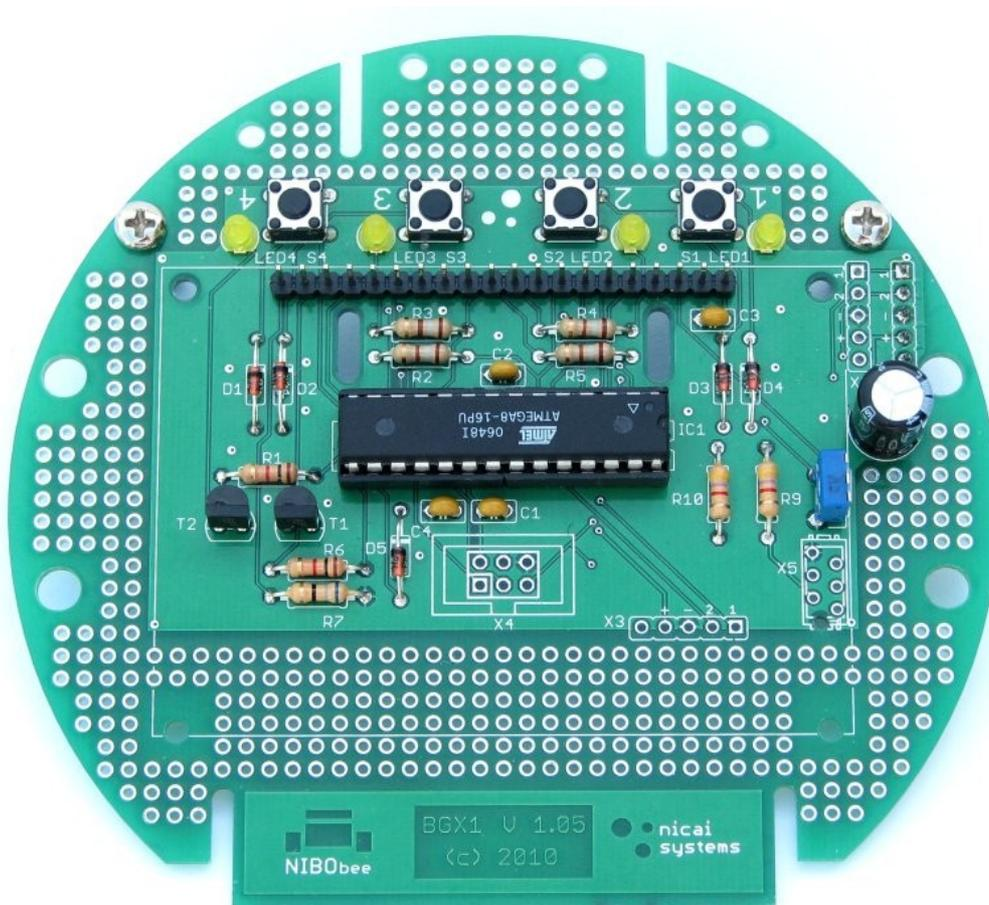
Die **Reihenfolge der Bestückung** richtet sich nach der Höhe der Bauteile, damit alle Lötstellen gut zugänglich sind. Die folgenden Unterabschnitte sind nach diesem Kriterium sortiert.
