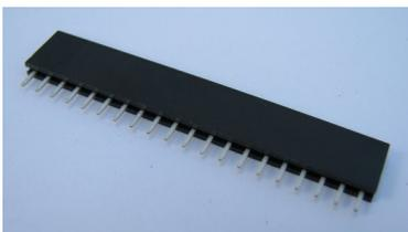
Die 20-polige Buchsenleiste wird auf der **Unterseite** der **Grafikdisplay-Platine** angelötet (siehe Foto, die Schraubbolzen werden erst später befestigt).
