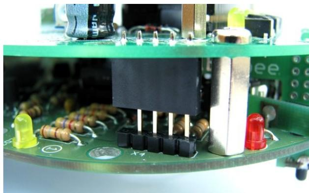
Abschließend werden die beiden Bolzen der BGX1-Platine mit den übrigen beiden M3-Kreuzschlitz Schrauben an der NIBObee-Platine festgeschraubt.
