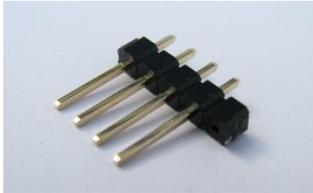
Die 4-polige Stiftleiste **X4** wird auf der **NIBObee-Hauptplatine** angelötet! Dabei ist darauf zu achten, dass die 4 Stifte an die Anschlüsse +, -, 2 und 1 angelötet werden. (siehe Foto).
