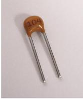
Die Platine wird mit vier Keramik-Vielschicht-Kondensatoren **C1 - C4** bestückt. Die Kondensatoren haben einen Wert von 100 nF (Aufdruck: 104). Es muss beim Einbau keine Polarität beachtet werden.
