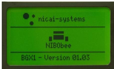
Falls Sie nichts sehen, muss vermutlich nur der Displaykontrast am Potentiometer R8 eingestellt werden.
