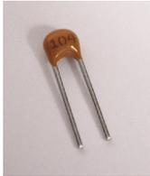
Die Platine wird mit vier Keramik-Vielschicht-Kondensatoren **C1 - C4** bestückt. Die Kondensatoren haben einen Wert von 100 nF (Aufdruck: 104). Es muss beim Einbau keine Polarität beachtet werden.
