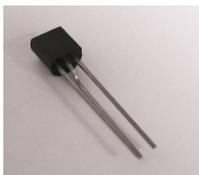
Die zwei PNP-Bipolar-Transistoren **T1** und **T2** sind vom Typ BC327. Bei der Bestückung ist darauf zu achten, dass die abgeflachte Seite der Transistoren in die gleiche **Orientierung** zeigt, wie auf der
