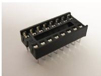
Es werden zwei **14-polige** IC-Sockel so nebeneinander eingelötet, dass man einen 28-poligen Sockel für den ATmega8 erhält. Die **Einkerbung beider** Sockel muss in die
