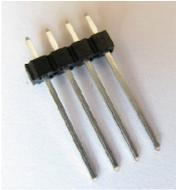
Die 4-polige Stiflleiste **X1** wird mit den langen Pinnen von oben in die vier **vorderen** (in Fahrtrichtung) Lötäugen **X1** der **BGX1-Platine** gesteckt und von der **Unterseite** der Platine fest gelötet.
