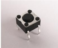
Der Einbau der Taster **S1 - S4** ist verpolungssicher. Sie müssen mit leichtem Druck bis zum Einrasten bestückt werden. Da das Pinout **nicht** quadratisch ist, sind nur **zwei** der vier Orientierungen möglich.
