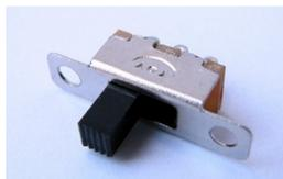
Der Schiebeschalter **S1** kann in zwei verschiedenen Orientierungen eingesetzt werden, die Funktionalität bleibt die gleiche.
