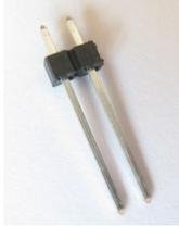
Die 2-poligen Stiftleisten **X1**, **X1B**, **X2**, **X3**, **X4** und **X4B** werden mit den langen Pinnen von oben in die jeweiligen Lötäugen der Berry-Platine gesteckt von der **Unterseite** der Platine fest gelötet.
