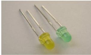
Die LEDs **LED1** (grüne LED) und **LED2** (rote LED) haben zwei Beinchen, ein kurzes (Kathode) und ein langes (Anode). Beim Einlöten muss die **Polarität** beachtet werden:
