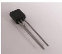
Der MOS-FET-Transistor **T1** ist vom Typ BS170. Bei der Bestückung ist darauf zu achten, dass die abgeflachte Seite des Transistors in die gleiche **Orientierung** zeigt, wie auf der Platine angegeben ist.
