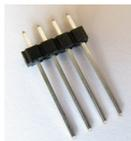
Die 4-polige Stiftleiste **X5** wird mit den langen Pinnen von oben in die vier **linken** (in Fahrtrichtung) Löttaugen **X5** der Berry-Platine gesteckt und von der **Unterseite** der Platine fest gelötet.
