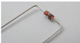
Die Schottky-Dioden **D1** und **D2** vom Typ BAT85 müssen vor der Bestückung wie die Widerstände zurecht gebogen werden. Dabei muss man jedoch auf die **Polarität**
