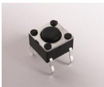
Der Einbau der Taster **S2** und **S3** ist verpolungssicher. Sie müssen mit leichtem Druck bis zum Einrasten bestückt werden. Da das Pinout **nicht** quadratisch ist, sind nur **zwei** der vier Orientierungen möglich.
