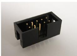
Die beiden Wannenstecker (X1 und X2) müssen in der richtigen **Orientierung** auf die Platine gelötet werden. Die Aussparungen an den Wannen sind auf dem Bestückungsdruck sichtbar. Die 6-polige Wanne X2 dient zur Programmierung des Roboters. Die 10-polige Wanne X1 dient zum Anschluss der Erweiterung an den NIBO2.
