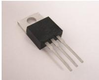
Der Spannungsregler IC2 wird stehend eingelötet. Achten Sie darauf, daß Sie das Bauteil bis zum Anschlag in die Platine schieben. Die Kühlfahne zeigt zum Platinenrand! Nach dem Einlöten muß der
