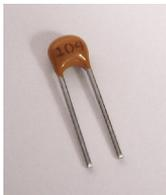
Die Platine wird mit vier Keramik-Vielschicht-Kondensatoren bestückt. Die Kondensatoren haben einen Wert von 100 nF (Aufdruck: 104). Es muss beim Einbau keine Polarität beachtet werden.
