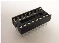
Für den ATtiny84 (IC1) wird ein Sockel auf der Platine eingelötet. Die **Einkerbung** im Sockel muss in die selbe Richtung zeigen, wie die Markierung auf der Platine. Der IC wird erst später in den Sockel gesteckt.
