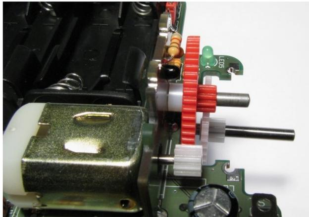
Das Getriebe wird mit der Platine ② fixiert (die Bauteile der Platine ② zeigen dabei nach innen). Anschließend wird die Abdeckplatte (siehe Foto) auf die Platinen ⑥ und ② mit leichtem Druck aufgespresst.
