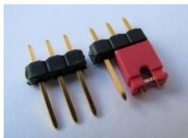
Die dreipoligen Jumperstecker **JP1, JP2, JP3** werden analog zum zweipoligen Jumper gelötet. Nach dem Einlöten werden die Jumper jeweils auf Pin1 und Pin2 gesteckt.
