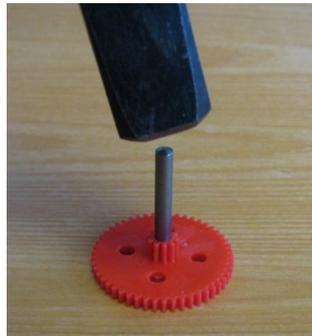
Danach wird die Achse **vorsichtig** mit dem Hammer durch die Bohrung getrieben. Das Zahnrad sollte sich anschließend in der Mitte der Achse befinden:
