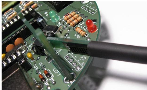
Beim Schrumpfen sollte darauf geachtet werden, daß der Lötkolben mindestens 3 mm vom Schrumpfschlauch entfernt bleibt.
