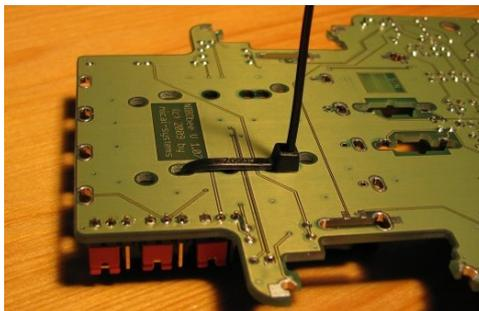
Nun wird der Kabelbinder bündig mit einem Seitenschneider abgeschnitten. Der andere Batteriehalter wird analog befestigt.
