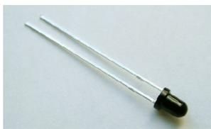
Die Phototransistoren **PT3-PT5** messen die reflektierte IR-Strahlung. Sie werden auf der **Platine ⑧** eingelötet. Dabei muss die **Polarität** beachtet werden: Das **kurze** Beinchen muss jeweils in das **rechteckige** Lötpad.
