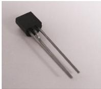
Die fünf PNP-Bipolar-Transistoren **T1, T2, T3, T6** und **T7** sind vom Typ BC327. Bei der Bestückung ist darauf zu achten, dass die abgeflachte Seite der Transistoren in die gleiche **Orientierung** zeigt, wie auf der Platine angegeben ist.
