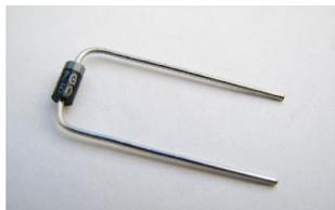
Auch die Silizium-Dioden **D1-D8** vom Typ 1N4007 müssen vor der Bestückung wie die Widerstände zurecht gebogen werden. Dabei muss auf die **Polarität** geachtet werden! Der weiße Strich bzw. das
