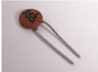
Die vier Scheibenkondensatoren **C1**, **C2**, **C12** und **C13** haben eine Kapazität von 22 pF (Aufdruck: 22), auf eine Polarität muss nicht geachtet werden.
