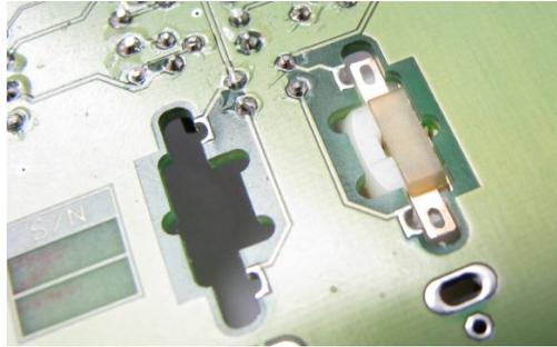
Nachdem der Motor richtig sitzt, wird die Platine ⑥ zunächst an der mittleren Lötstelle an der Hauptplatine fest gelötet (siehe Fotos).
