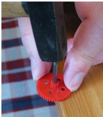
Nun werden die beiden **weißen** Zahnräder auf die beiden **langen** Stahlachsen (3x37 mm) aufgespresst.
