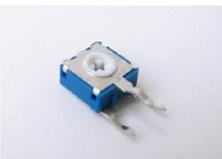
Beim Einbau des Potentiometers **R29** muss auf die richtige **Orientierung** geachtet werden. Der Einbau ist nur in einer Richtung möglich. Das Potentiometer dient zum Einstellen der
