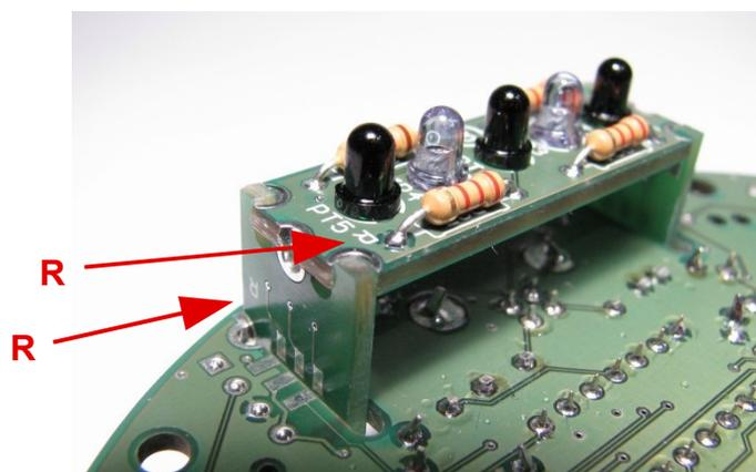
Wenn alles **gut ausgerichtet** ist, werden die Platinen nun mechanisch mit einander verlötet. Von den 6 Lötstellen der Platine ⑧ werden zunächst nur die **mittleren** beiden Stellen fest gelötet (rote Pfeile). Dann lötet man die Platinen ④ und ⑤ an der Hauptplatine fest (weiße Pfeile):
