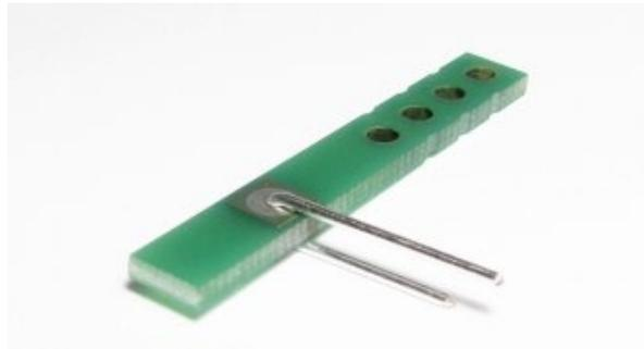
Der Draht wird von beiden Seiten an den Lötspots der Hilfsplatinen angelötet und anschließend durch die Bohrlöcher der Hauptplatine gesteckt:
