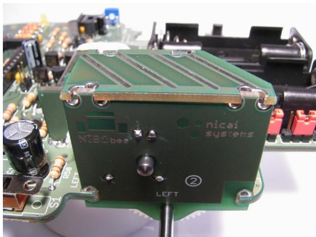
Von außen wird die Platine an vier Stellen fest gelötet:
