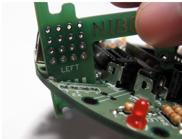
Von der Unterseite soll nun Platine ⑧ aufgesteckt werden. Dazu hält man die Platinen ④ und ⑤ fest, dreht die Hauptplatine um und steckt Platine ⑧ so auf, dass man die Bauteile sehen kann. Dabei muss jedoch die **Orientierung** beachtet werden: die Platinen sind jeweils mit **R** und **L** gekennzeichnet.
