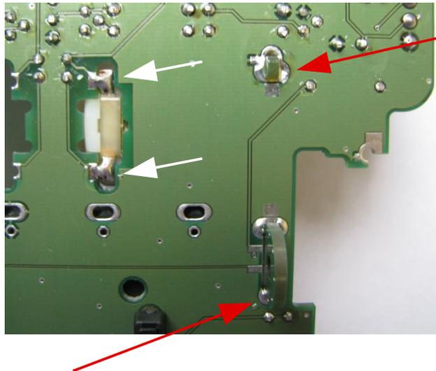
Weiterhin werden die Motorkontakte an der Platine fest gelötet (weiße Pfeile).
