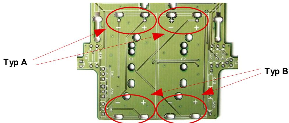
Die + bzw. - Markierung muß **nur an der Seite mit den Lötkontakten** mit den Markierungen auf der Platine übereinstimmen.
