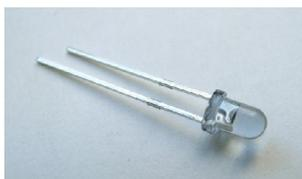
Die IR-LEDs IR3 und IR4 werden auf der **Platine ⑧** eingelötet. Dabei muss die **Polarität** beachtet werden: Das **kurze** Beinchen muss jeweils in
