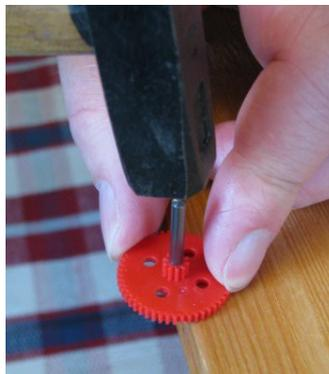
Nun werden die beiden **weißen** Zahnräder auf die beiden **langen** Stahlachsen (3x37 mm) aufgespresst.
