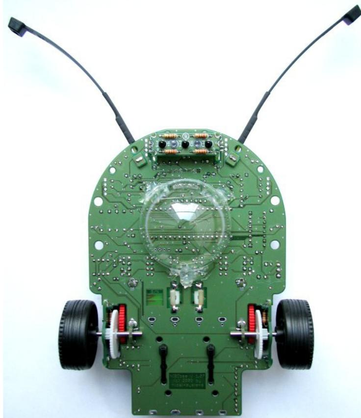
Abschließend wird noch die große Halbsphäre aufgesetzt – jetzt ist der NIBObee startklar!
