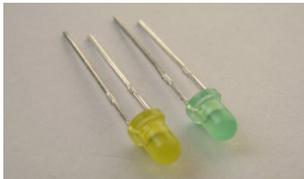
Die LEDs **LED0 - LED6** haben zwei Beinchen, ein kurzes (Kathode) und ein langes (Anode). Beim Einlöten muss die **Polarität** beachtet werden: **!! Wichtig !!** Das **kurze** Beinchen muss jeweils in das **rechteckige** Lötpad.
