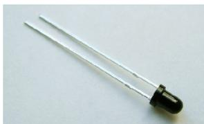
Die Phototransistoren **PT3-PT5** messen die reflektierte IR-Strahlung. Sie werden auf der **Platine ⑧** eingelötet. Dabei muss die **Polarität** beachtet werden:
