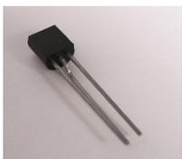
Die vier NPN-Bipolar-Transistoren **T4**, **T5**, **T8** und **T9** sind vom Typ BC337. Bei der Bestückung ist darauf zu achten, dass die abgeflachte Seite der Transistoren in die gleiche **Orientierung**
