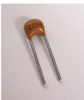
Die Platine wird mit insgesamt zehn Keramik-Vielschicht-Kondensatoren bestückt. Dabei haben die Kondensatoren C9 und C10 einen Wert von 10 nF (Aufdruck: 103). C9 wird auf **Platine ⑥**, C10 wird auf **Platine ⑦** bestückt.
