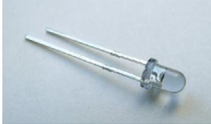
Die IR-LEDs IR3 und IR4 werden auf der **Platine ②** eingelötet. Dabei muss die **Polarität** beachtet werden: Das **kurze** Beinchen muss jeweils in das **rechteckige** Lötpad. IR1 wird
