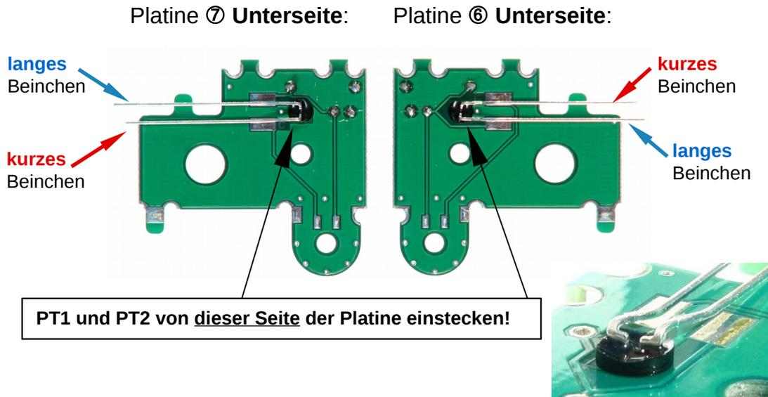
Dann werden die Beinchen **gekürzt** (sie müssen **kürzer** sein als das **Pad**, damit später kein Kurzschluss mit den Motor-Gehäusen entsteht!)
