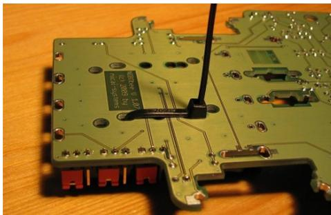
Nun wird der Kabelbinder bündig mit einem Seitenschneider abgeschnitten.
