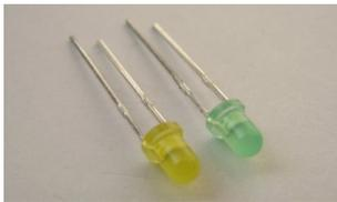
Die LEDs **LED0 - LED6** haben zwei Beinchen, ein kurzes (Kathode) und ein langes (Anode). Beim Einlöten muss die **Polarität** beachtet werden: **!! Wichtig !!** Das **kurze** Beinchen muss jeweils in das **rechteckige** Lötpad.
