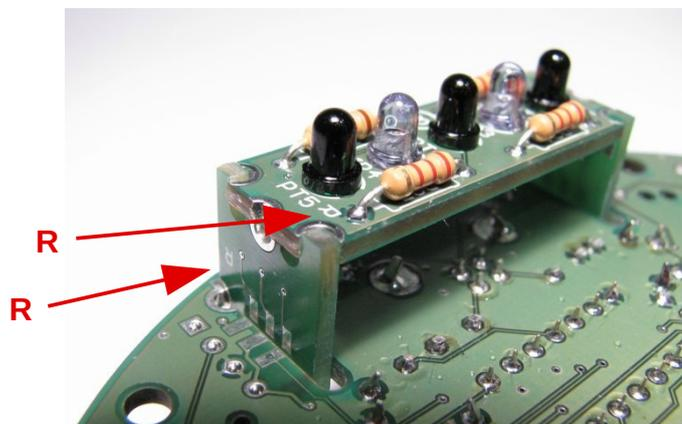
Wenn alles **gut ausgerichtet** ist, werden die Platinen nun mechanisch mit einander verlötet. Von den 6 Lötstellen der Platine ⑥ werden zunächst nur die **mittleren** beiden Stellen fest gelötet (rote Pfeile). Dann lötet man die Platinen ④ und ⑤ an der Hauptplatine fest (weiße Pfeile):
