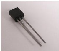
Die vier NPN-Bipolar-Transistoren **T4**, **T5**, **T8** und **T9** sind vom Typ BC337. Bei der Bestückung ist darauf zu achten, dass die abgeflachte Seite der Transistoren in die gleiche **Orientierung** zeigt, wie auf der Platine angegeben ist.
