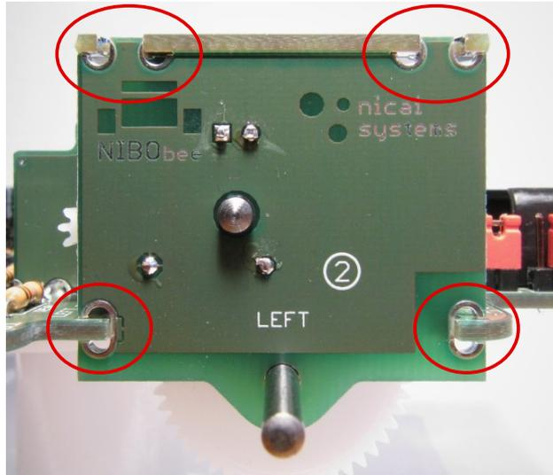
Auch hierbei wird wieder **relativ wenig Lötzinn** verwendet, und jede Lötstelle wird noch ca. 10 Sekunden zusätzlich erhitzt.
