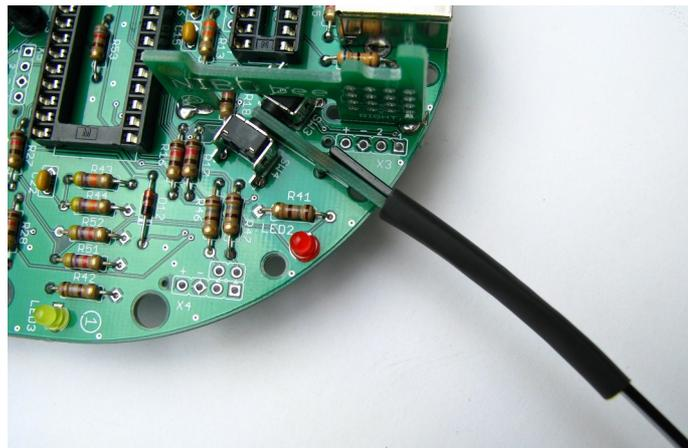
Beim Schrumpfen sollte darauf geachtet werden, daß der LötKolben mindestens 3 mm vom Schrumpfschlauch entfernt bleibt.
