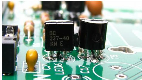
**!! Wichtig !!** Der NIBObee darf niemals **ohne bestückten IC3 (74HC139)** eingeschaltet werden, da sonst die **Transistoren zerstört** werden!
