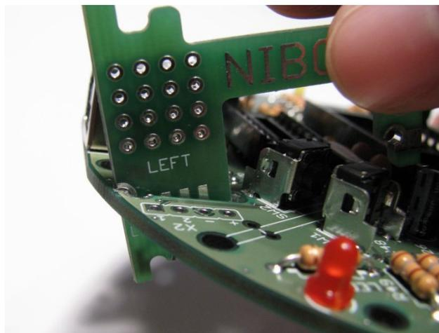
Von der Unterseite soll nun Platine ⑥ aufgesteckt werden. Dazu hält man die Platinen ④ und ⑤ fest, dreht die Hauptplatine um und steckt Platine ⑥ so auf, dass man die Bauteile sehen kann. Dabei muss jedoch die **Orientierung** beachtet werden: die Platinen sind jeweils mit **R** und **L** gekennzeichnet.
