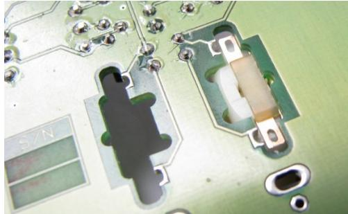
Nachdem der Motor richtig sitzt, wird die Platine ⑥ zunächst an der mittleren Lötstelle an der Hauptplatine fest gelötet (siehe Fotos).
