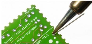
Dann hält man **zusätzlich** das **Lötzinn** an das Lötpad. Wenn alles heiß genug ist, schmilzt das Lötzinn und verbindet so das Beinchen mit dem Lötpad:
