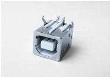
Beim Einbau der USB-Buchse **X6** sollte darauf geachtet werden, dass die kleineren Pinne nicht verbogen sind. Das Bauteil ist verpolungssicher. Die Buchse wird an insgesamt **6** Stellen angelötet.
