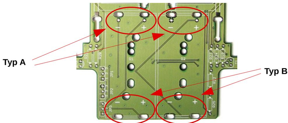
Die + bzw. - Markierung muss **nur an der Seite mit den Lötkontakten** mit
