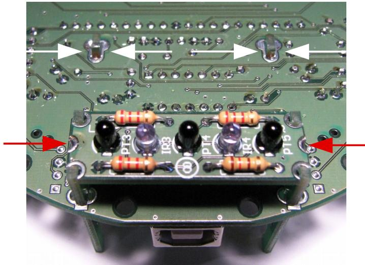
Jetzt sollte der mechanische Aufbau fest sitzen. Zum Abschluss werden noch die übrigen Kontakte auf **beiden Seiten** (insgesamt **12** Stück) hergestellt:
