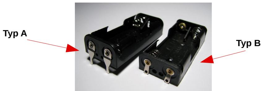
Beim Einbau orientiert man sich an den +/- Beschriftungen auf der Hauptplatine und an den +/- Beschriftungen in den jeweiligen Batteriehaltern auf der **Seite der Lötkontakte** (äußere Anschlusslaschen):
