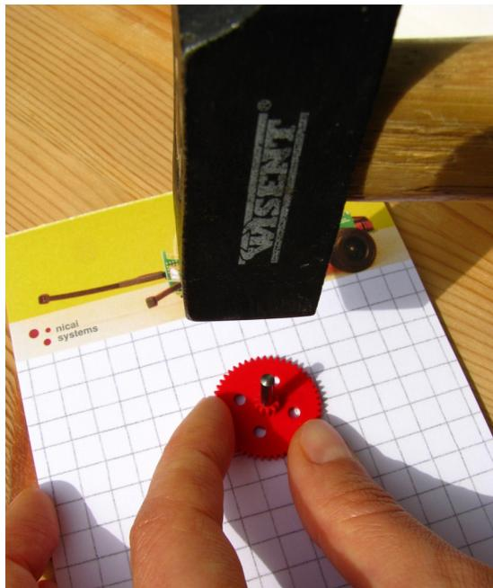
Die Achse wird dann mit dem Hammer in etwa so weit eingetrieben:
