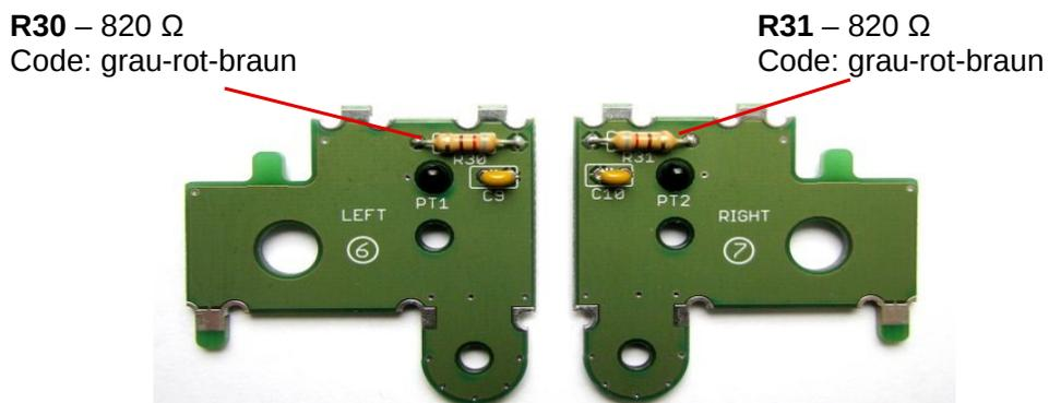
**Hinweis:** Die Widerstände und die Kondensatoren der Platinen ⑥ und ⑦ müssen ganz **bündig** eingelötet werden, da sie sonst später dem Getriebe im Weg sind!
