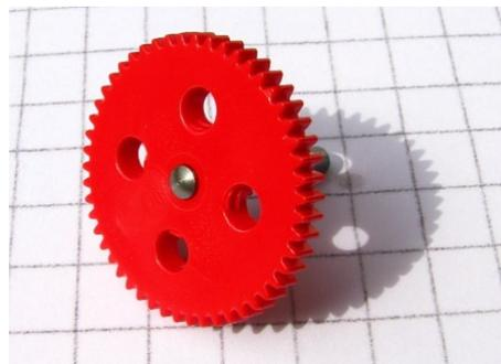
Danach wird die Achse **vorsichtig** per Hand durch die Bohrung gedrückt. Dabei sollten die **Daumennägel** weit genug **von der Achse entfernt** sein, um sich nicht zu verletzen:
