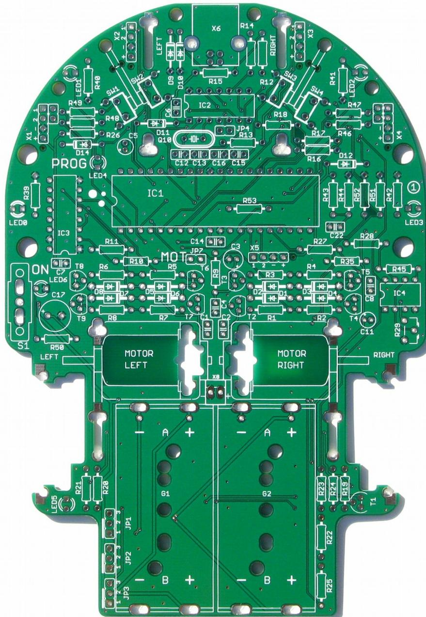
Alle Platinen müssen zunächst z.B. mittels einer Kombizange aus dem Rahmen heraus gebrochen und voneinander getrennt werden:
