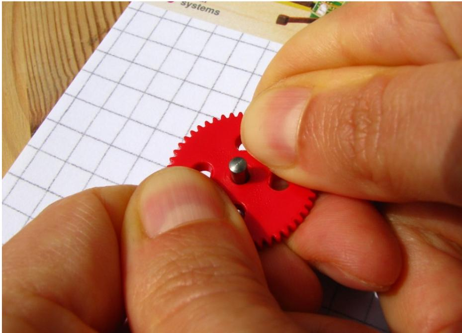
Das Zahnrad sollte sich anschließend in der **Mitte** der Achse befinden:
