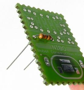
Jetzt erhitzt man von der **Unterseite** der Platine mit der Lötkolbenspitze **gleichzeitig** das **Lötpad** und das **Bauteilbeinchen**:
