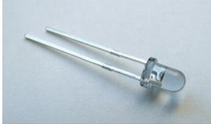
Die IR-LEDs IR3 und IR4 werden auf der **Platine ②** eingelötet. Dabei muss die **Polarität** beachtet werden: Das **kurze** Beinchen muss jeweils in das **rechteckige** Lötpad.
