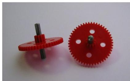
Nun werden die beiden **weißen** Zahnräder auf die beiden **langen** Stahlachsen (3 x 37 mm) aufgepresst.
