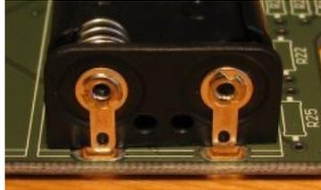
Bei den Batteriehaltern vom **Typ A** zeigen die Anschlußlaschen zur **Platinenmitte** hin.
