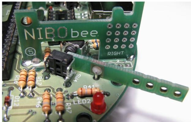
Von der Unterseite wird das Ganze mit den kleinen viereckigen Hilfsplatinen fixiert, die zunächst aufgesteckt und dann fest gelötet werden:
