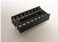
Es werden insgesamt vier IC-Sockel eingelötet. Für den Hauptcontroller ATmega16 wird der 40-polige, für den ATtiny44 wird der **14-polige**, für den
