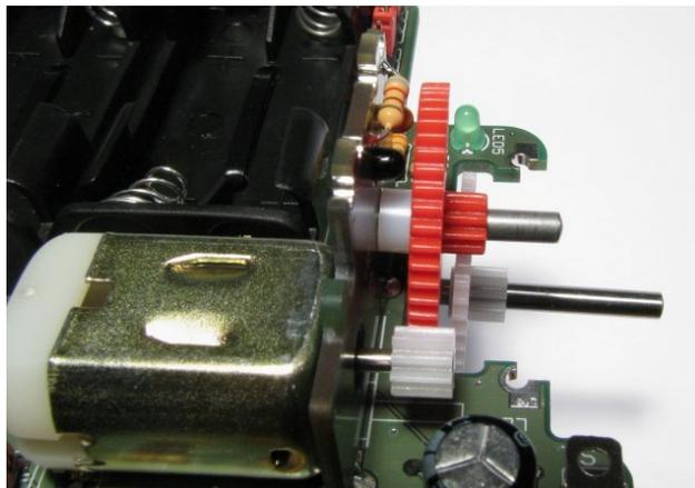
Das Getriebe wird mit der Platine ② fixiert (die Bauteile der Platine ② zeigen dabei nach innen). Anschließend wird die Abdeckplatte (siehe Foto) auf die Platinen ⑥ und ② mit leichtem Druck aufgepresst.
