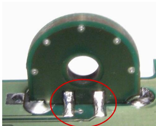
**Tip:** Man sollte diese Kontakte **nicht vor den mechanischen Verbindungen** anlöten, da sonst durch Biegen an den dann noch nicht festen Platinenteilen die Löt pads abreißen können!
