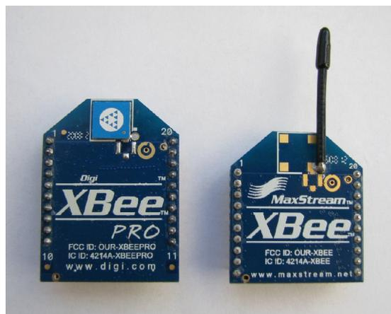
Der Unterschied der Module liegt hauptsächlich in deren Sendeleistung: Das XBee® -Modul hat eine Reichweite von bis zu 30 m in Innenräumen und bis zu 100 m in Außenumgebungen. Das XBee-PRO®-Modul hat eine Reichweite von bis zu 100 m in Innenräumen und bis zu 1600 m in Außenumgebungen. Die Reichweiten in den Außenumgebungen ist stark abhängig von den jeweiligen Umgebungsbedingungen.
