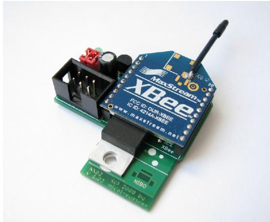
Jetzt wird die ganze Platine rechts neben der 6-poligen Wanne am NIBO2 befestigt. Dazu wird zunächst 6-polige Anschlusskabel in den Wannenstecker auf der NIBO2-Platine gesteckt. Nun wird die vordere Innensechskantschraube von der Aluminiumabdeckplatte gelöst und anschließend inklusive Spannungswandler, Adapterplatine und Abdeckplatte wieder festgeschraubt. Abschließend wird das Anschlusskabel in die Wanne auf der Adapterplatine gesteckt.
