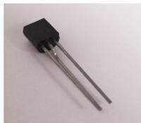
Der N-MOSFET-Transistor T1 ist vom Typ BS170. Bei der Bestückung ist darauf zu achten, dass die abgeflachte Seite der Transistoren in die gleiche **Orientierung** zeigt, wie auf der Platine angegeben ist.
