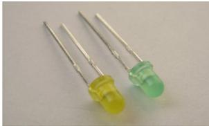
Die beiden LEDs LED1 (grün) und LED2 (gelb) haben zwei Beinchen, ein kurzes (Kathode) und ein langes Anode. Das **kurze** Beinchen muss zum **Platinenrand** hin zeigen. Als weiteres Merkmal ist das Gehäuse in Richtung des kurzen Beinchens abgeflacht.
