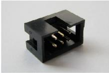
Der Wannenstecker X1 muss in der richtigen **Orientierung** auf die Platine gelötet werden. Die Aussparungen an den Wannensind auf dem Bestückungsdruck sichtbar. Die Wanne dient zum Anschluss der Platine an den Nibo2.
