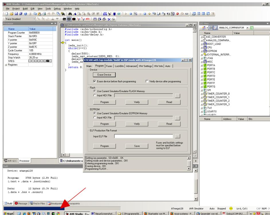
Die Programmübertragung wird mittels Verlaufs Balken am unteren Fensterrand visualisiert.
