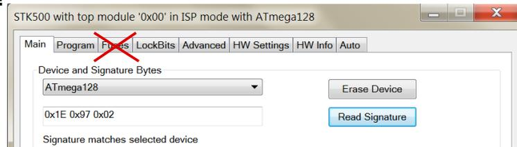
Im Tabsheet „Fuses“ dürfen **keine Änderungen** vorgenommen werden! Die Fuse-Bits des ATmega128 sind standardmäßig auf folgende Werte eingestellt: EXTENDED=0xFF, HIGH=0xC1, LOW=0xFF. Diese Werte **dürfen nicht** geändert werden, da man sich sonst aus dem Controller aussperrt!!! Weitere Infos unter: <http://www.nibo-roboter.de/wiki/Ausgesperrt>
