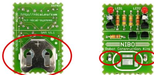
Zum Betrieb des SAM-Moduls muss abschließend noch eine **CR2025 3V** Lithium-Knopfzelle eingelegt werden:
