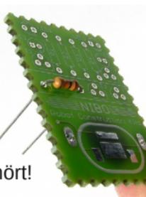
Jetzt erhitzt man von der **Unterseite** der Platine mit der LötKolbenspitze **gleichzeitig** das **Lötpad** und das **Bauteilbeinchen**:
