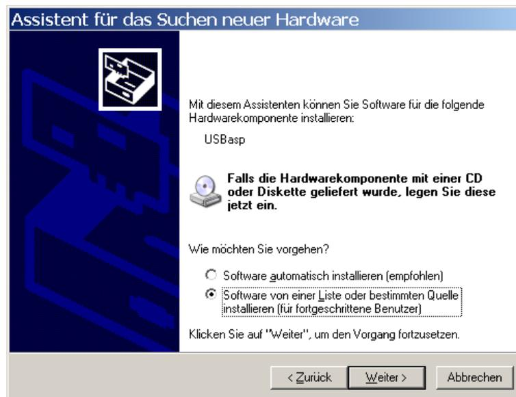
Im anschließenden Dialog wird die Option „**Software von einer Liste oder bestimmten Quelle installieren (für fortgeschrittene Benutzer)**“ ausgewählt und mit „**Weiter**“ bestätigt. Im folgenden Dialog wird der Punkt „**Diese Quellen nach dem zutreffendsten Treiber durchsuchen**“ ausgewählt:
